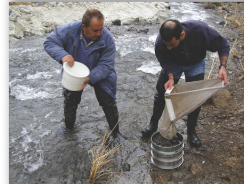
Ξέπλυμα και κοσκίνισμα του δείγματος
