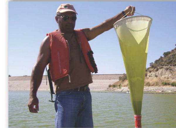
Παράλληλα συλλέγεται ποιοτικό δείγμα φυτοπλαγκτού με ειδικό δίκτυο. Το δείγμα αυτό περιέχει ζωντανό φυτοπλαγκτό, γι' αυτό κατά τη μεταφορά του στο εργαστήριο βιολογίας του ΤΑΥ διαπρέπει στο σκοτάδι και αναλύεται με τη χρήση αναστροφικού μικροσκοπίου, εντός 24 ωρών από την ώρα συλλογής του.
