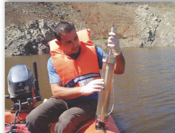
Από τη σπύλη του νερού της εύρωτης ζώνης λαμβάνεται με τη χρήση δειγματολήπτη τύπου «Integrating Water Sampler» ή τύπου «Ruttner» (Φωτο), ποσοτικό δείγμα φυτοπλαγκτού και δείγμα νερού για αναλύσεις χλωροφύλλης α, υποστρεπτικές αναλύσεις θρεπτικών ουσιών και άλλες αναλύσεις (επικίνδυνων χημικών ουσιών, BOD & COD, μικροβιολογικές, οικολογολογικές αναλύσεις κ.ά.).
