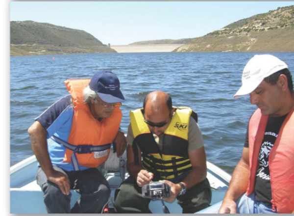
Στην εύρωτη ζώνη, στο βαθύτερο σημείο και σε ενδιάμεσα βάθη πραγματοποιούνται μετρήσεις φυσικοχημικών παραμέτρων. Για το σκοπό αυτό χρησιμοποιείται πολυμετρικός και προδιορίζονται η θερμοκρασία, η ηλεκτρική αγωγιμότητα, η θολότητα, το pH και το διαλυμένο οξυγόνο.
